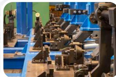
**«УАЗ-ТЕХИНСТРУМЕНТ» спроектировал и изготовил стенд для сварки самосвальных платформ грузовых автомобилей.**
