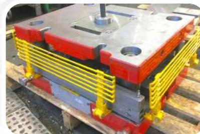
«УАЗ-ТЕХИНСТРУМЕНТ» изготовил комплект штампов холодной листовой штамповки.
