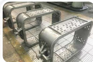
**«УАЗ-ТЕХИНСТРУМЕНТ» изготовил литейные опоки для металлургического производства одного из крупнейших заводов России.**
