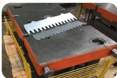
В потоке – восемь штампов для выполнения штамповки полного цикла: от заготовки до формообразования. Изделия позволяют получить восемь типоразмеров деталей. Это делает производственный процесс оптимальным, способствует повышению эффективности и достижению экономии. Так, на одних четырех штампах выполняется вырубка заготовки, на других четырех – формовка и гибка.
