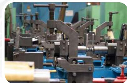
**«УАЗ-ТЕХИНСТРУМЕНТ» разработал приспособление для сборки и сварки подрамника несущего узла грузового автомобиля.**
