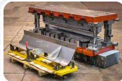
«УАЗ-ТЕХИНСТРУМЕНТ» выпустил гибочный штамп средних размеров для изготовления корпусной детали.
